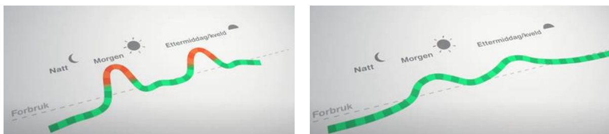
Figur 5.1. Illustrasjon av ønsket endring av strømforbruket som følge av effektbasert nettleie for en husholdning. Hentet fra en film fra Fornybar Norge.
