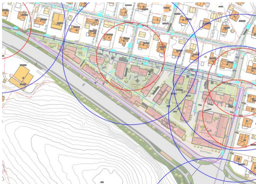
Figur 9: Brannvannsdekning gjennom kommunale uttak (Sweco Norge AS)
