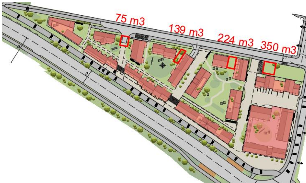
Figur 12: Rød innramming viser foreløpig plassering og størrelse av fordrøyningsmagasiner (Sweco Norge AS)
