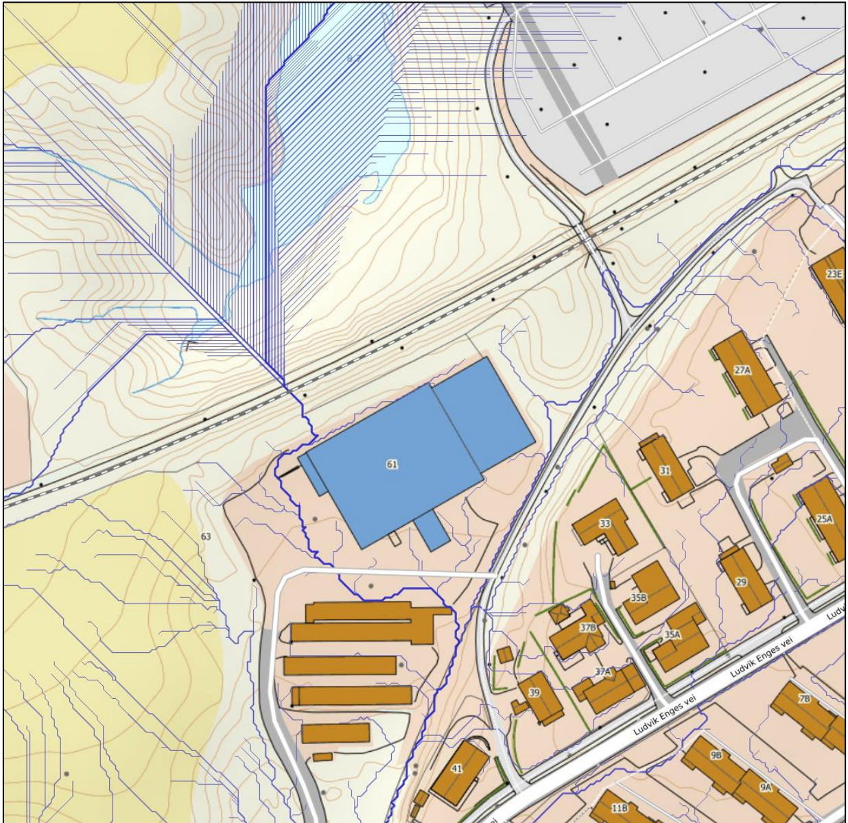
Fig 7 – Avrenningslinjer fra simulering i ScalGo.
