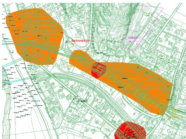
Figur 7-9: Omtrentlig utstrekning av kvikkleire (rød) og sprøbruddsleire (oransje) på Greåker
