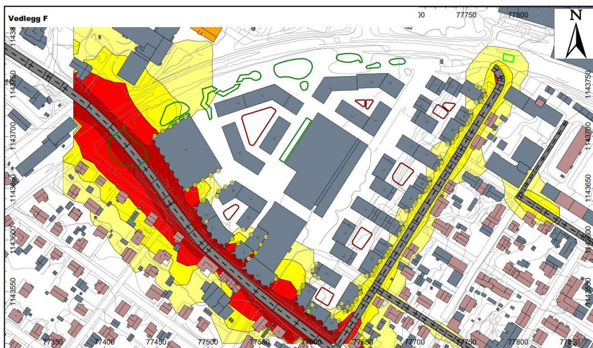
Figur 4-5: Beregning vegtrafikkstøy for fremtidig situasjon 2041 dersom Nordkapps gate blir stengt. Se også Vedlegg F.
