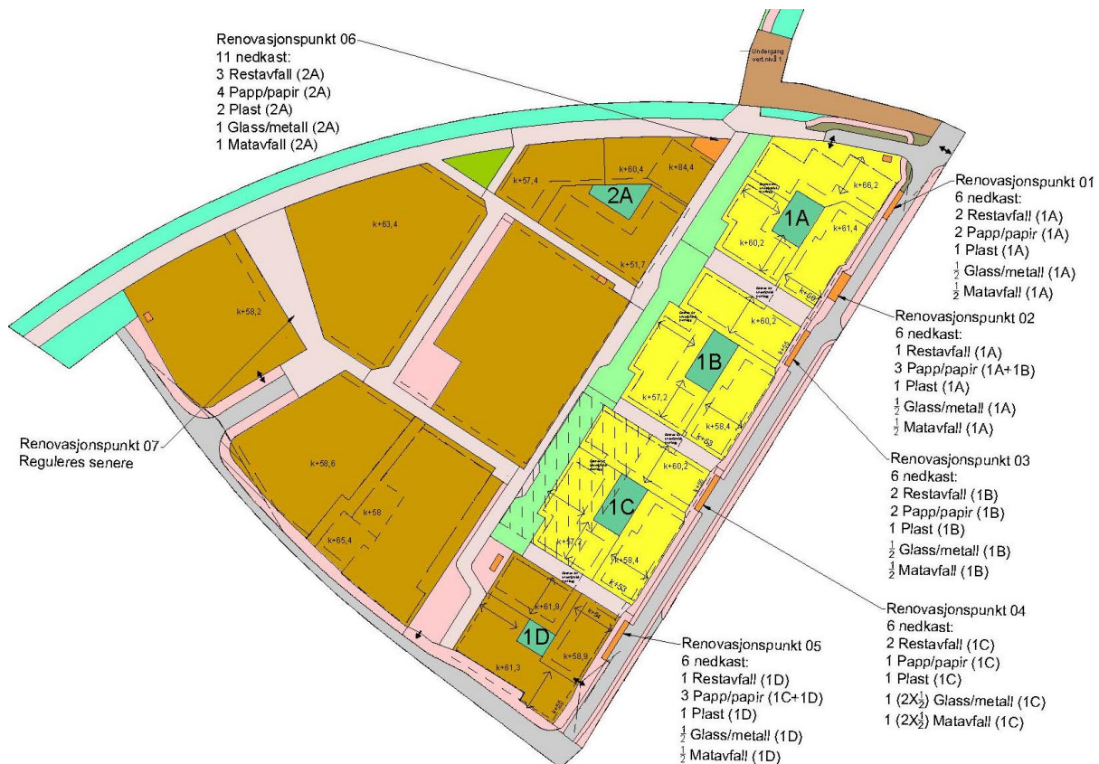
Figur 19 Plankart med markering av renovasjonspunkt og fordeling av fraksjoner for hvert kvartal. Det benyttes delte containere i noen av brønnene. Dette sikrer at alle kategorier er inkludert i alle punkt. Kvartal 1B får dekket kapasitetsbehov for papp i renovasjonspunkt 02. Kvartal 1C får dekket kapasitetsbehov for papp i renovasjonspunkt 05. (Se også tabell Figur16).
