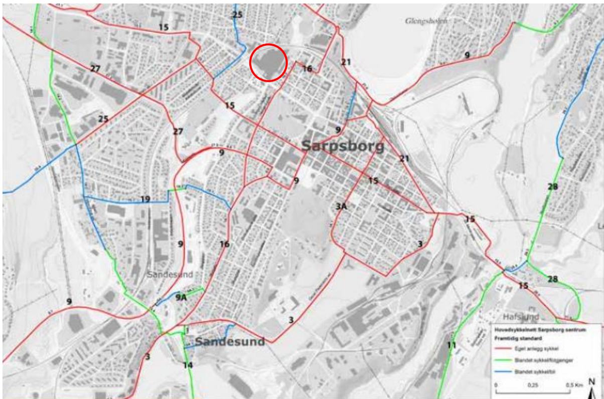
Figur 2-16. Hovedvegnett for sykkel i Sarpsborg. Planområdet er markert med rød sirkel. Fargene symboliserer fremtidig standard, hvor rødt er eget sykkelanlegg, grønt blandet sykkel/fotgjenger og blått blandet sykkel/bil. Kilde: Hovedsykkelveier i Sarpsborg og Fredrikstad, bypakke Nedre Glomma, 2017.
