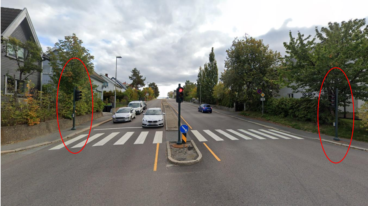
Figur 2-12 Tosidig fortau langs Olav Haraldssons gate østover fra krysset ved Follogata. Signalstolper midt i fortauet markert med rød sirkel. Foto: Google StreetView.
