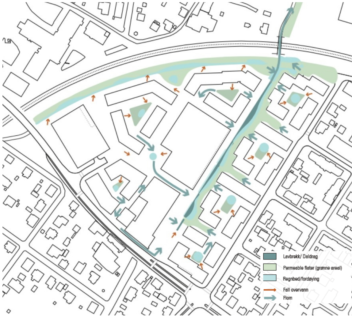
Figur 103 Prinsipp for overvannshåndtering og flom på Pappen som naturlig element i landskapsutforming..
