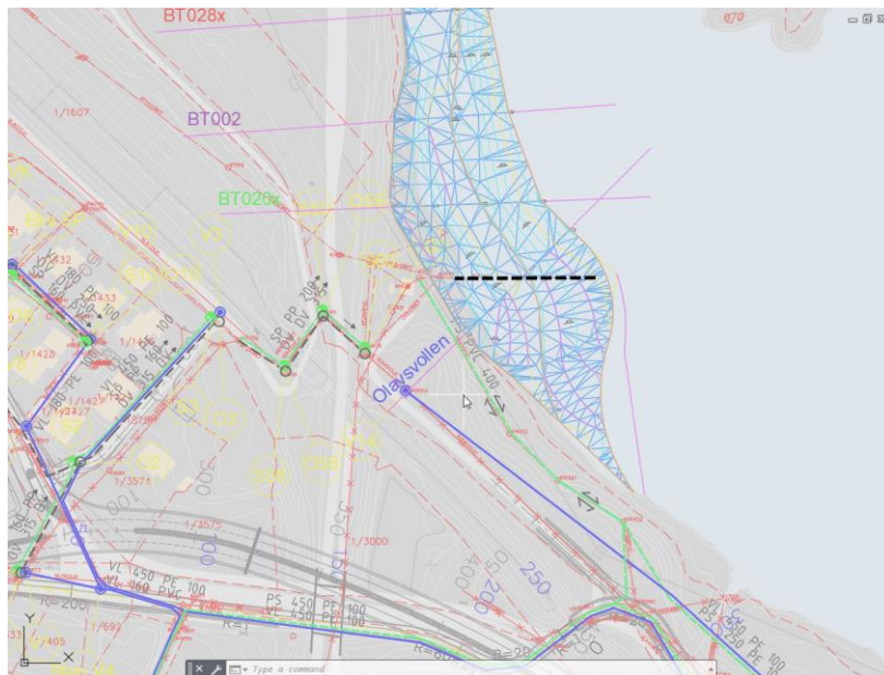
Figur 17 Viser fylling i Glomma og rør som må forlenges.
