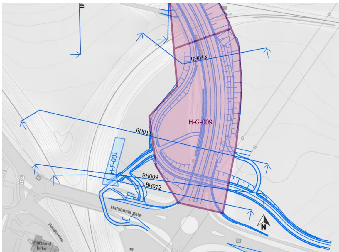
Figur 13-1: Snitt BH009, BH011, BH012 og BH013. Planlagt tiltak er markert med blå linjer/polygoner. H-F-001 er avlastingstiltak og H-G-009 er planlagt veifylling i EPS.
