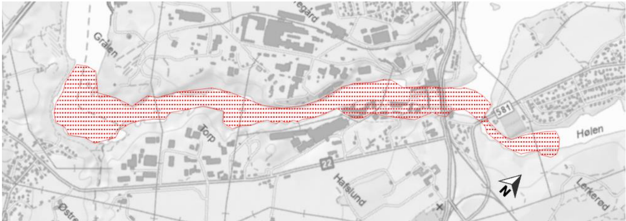
Figur 5-17: Oppdatert utløpsområde for kvikkleiresone «Nordbyveien». Se også vedlegg C.
