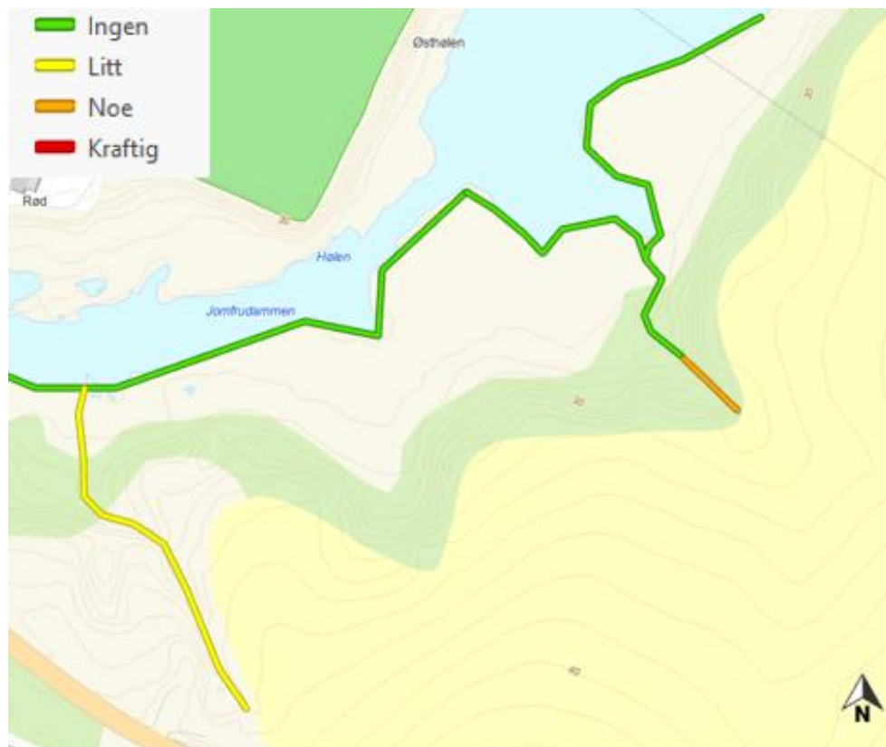
Figur 5-24: Erosjon i sideraviner på jordet ved Jomfrudammen som må følges opp.
