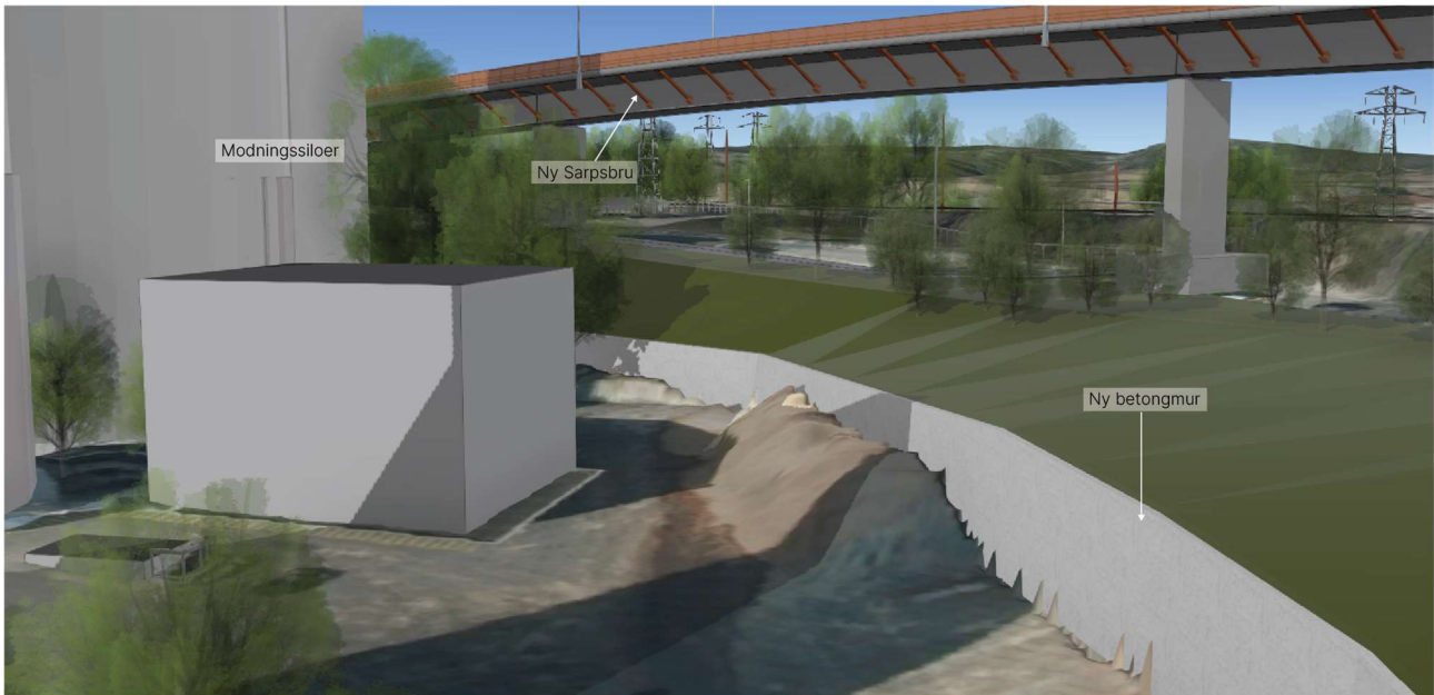
Figur 2-10: Illustrasjon som viser støttemur i betong (utsnitt fra 3D-modell).
