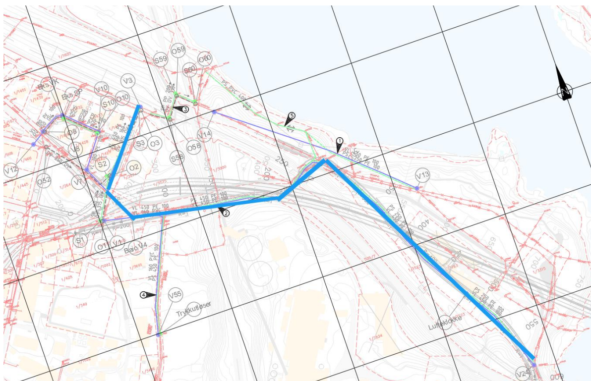
Figur 6-27: Blå strek indikerer permanent omlegging av overføringsledning for vann for Sarpsborg kommune.
