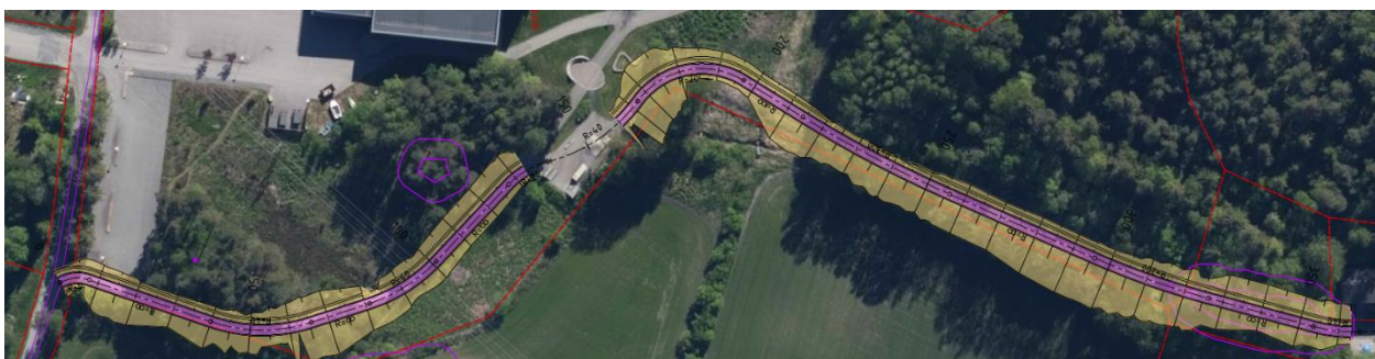
Figur 12 - Skisse av øvre del av søndre trase. Alternativ 1 er vist (kilde: Sweco)
