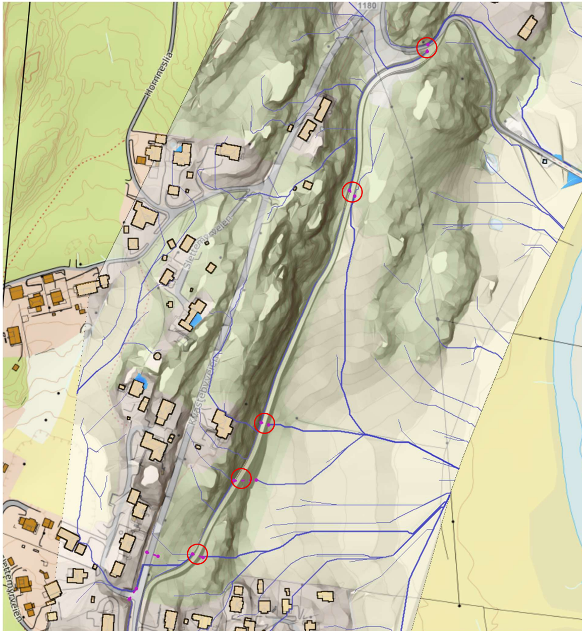
Fig 4 – Plassering av stikkrenner merket med røde sirkler.
