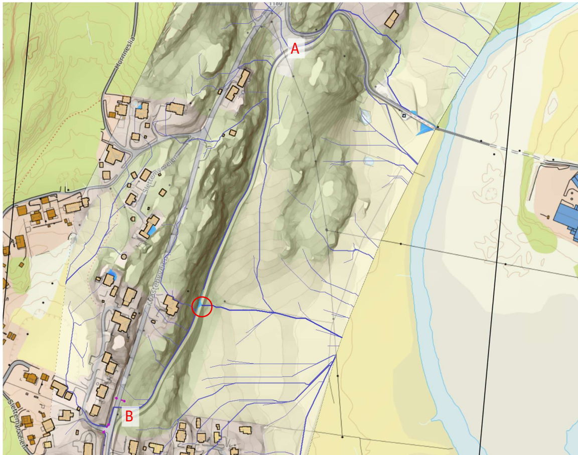
Fig 3 – Avrenningen etter etablering av GS-vei. Man ser tydelig hvordan GS-veien avskjærer drenslinjene. Disse samles i et punkt merket med rød sirkel.
