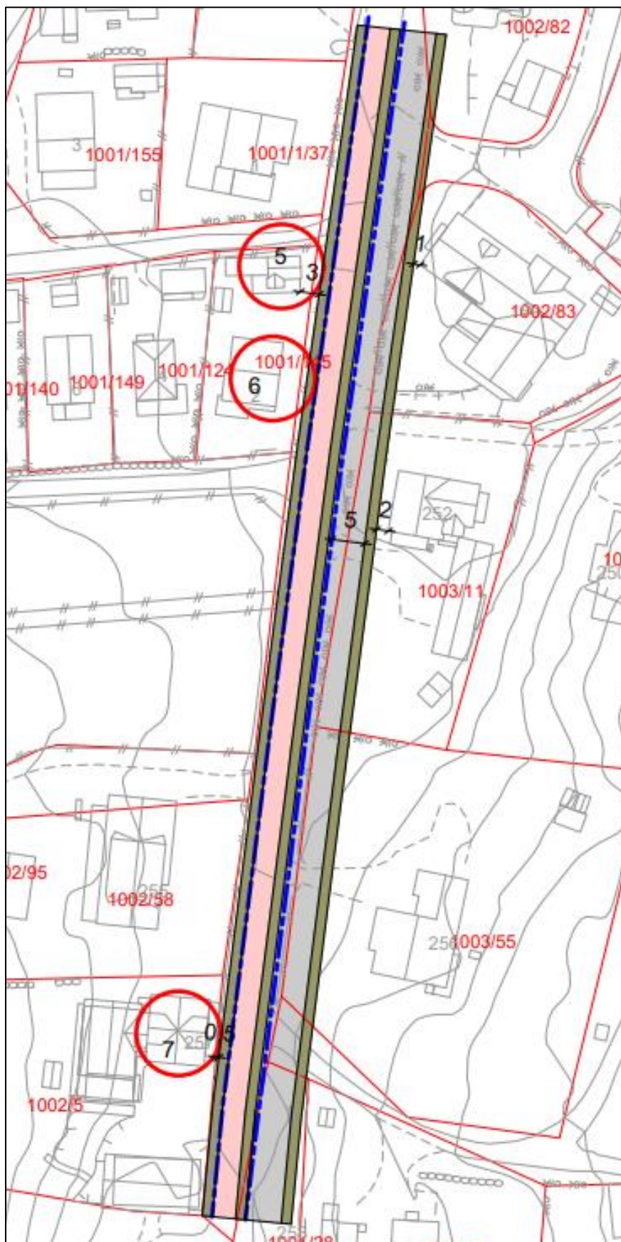
Figur 5: Illustrasjon som viser sideforskyvning av Kvastebyveien mot øst. Dagens kjørebane kant er vist med blå streker. Illustrasjonen understreker at det er lite «ekstra» areal å oppdrive på vestsiden. Som man kan se er det tatt utgangspunkt i gang- og sykkelvei (6,5 meter) og ikke fortau (5 meter).
