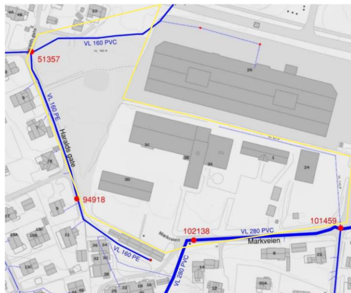
Figur 1: Vannledninger og brannkummer
