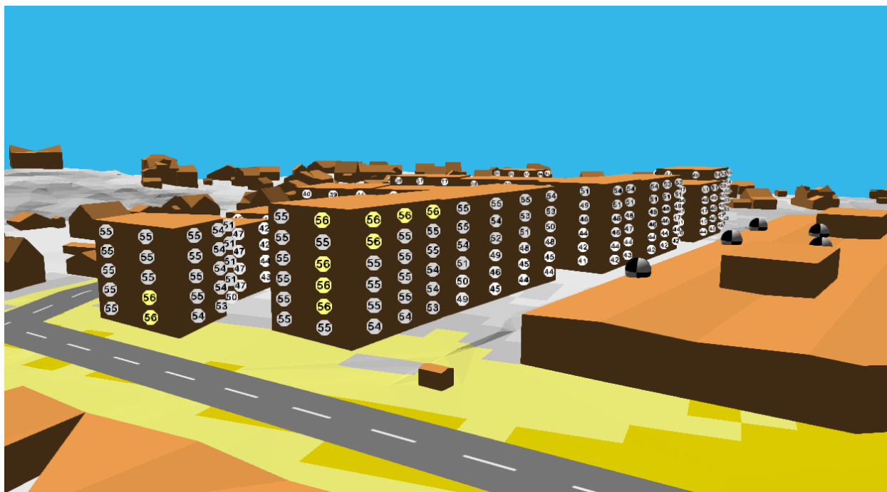
Figur 5-2: 3D-utsnitt fra modellen som viser støynivå på fasade sett fra nordøst
