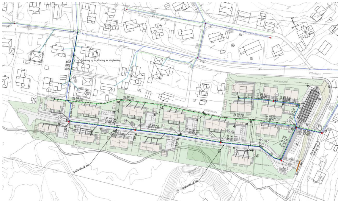
Over: Konsept VA (vedlegg VA-ledningsplan, Svendsen & Co)
