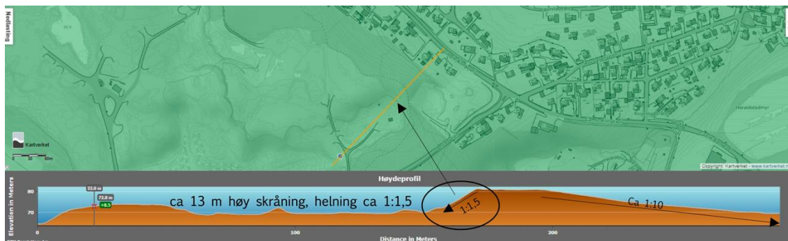
Over: Vurderingsprofil skråning (Vedlegg Geoteknisk rapport)
