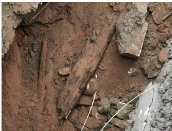
Figur 39: Sand og trebjelker på dybde 3-4 m
