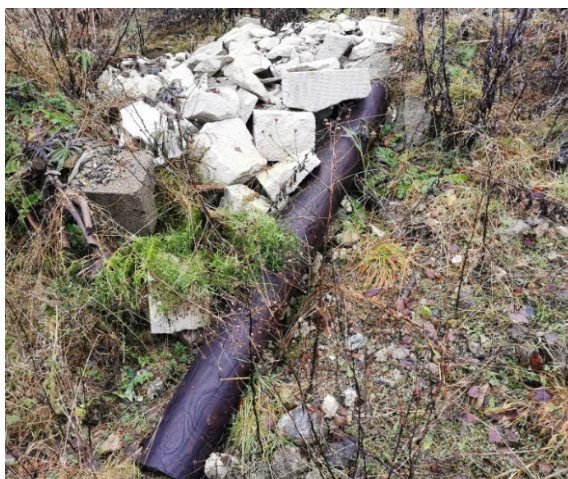
Figur 115 Kreosotimpregnert trestolpe og bygningsmaterialer ved punkt 4
