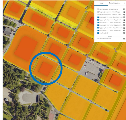
Figur 7- Kvartalet er markert med blå sirkel på utsnitt fra 3d modell som viser ytre og indre gesims og mulighet for et volum inntil 28,5 m.
