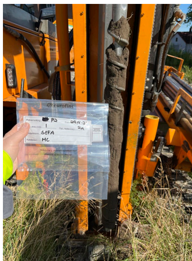
Figur 12. Bilde fra prøvepunkt P2. Bildet viser undersøkte jordmasser i vollen tilgrensende til fortau vest på tomta. Som bildet viser var massene her bestående av sandig silt med iblandet organisk materiale. Leire under.
