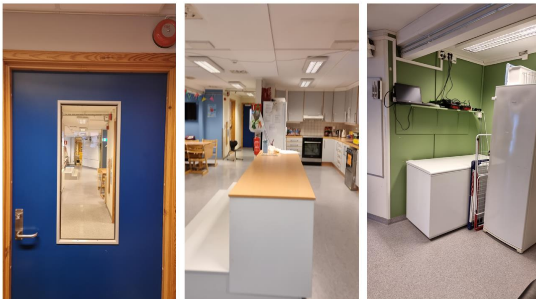
Figur 22 Bildene det er gjort tiltak med glass i dører for å bedre mulighet for kommunikasjon mellom rom. Barnehagens felles kjøkken benyttes til mange formål og er godkjent for lek og opphold, uten at krav til dagslys, utsyn og lyd er ivaretatt. På grunn av manglende nærlagerfunksjoner lagres kjøleskap, fryser og traller i LOA. Barns sikkerhet er ikke i stor nok grad ivaretatt i kjøkkenet. Steamer og komfyr er lett tilgjengelig.
