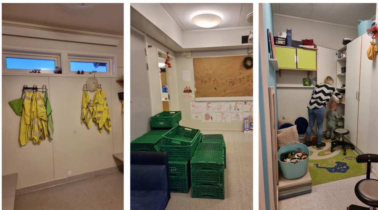
Figur 38 Bildene 1 eksempler på som er godkjent som LOA, men som ikke tilfredsstiller krav til dagslys og utsyn. På bilde 3 ser vi eksempel på lagring i skap, der det ikke er trukket fra areal i LOA.
