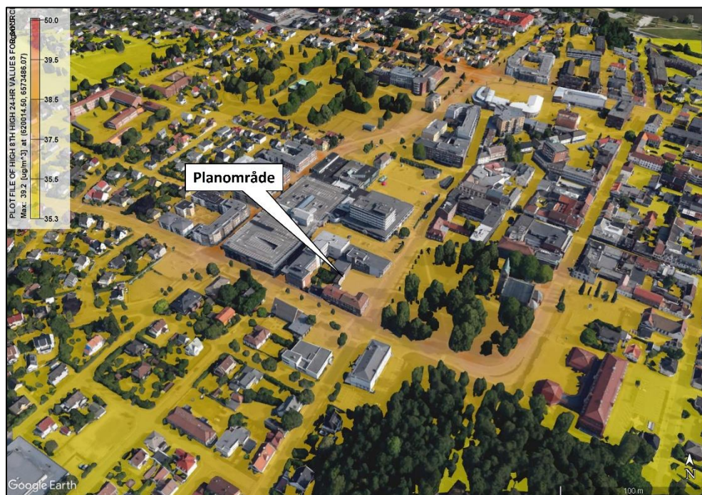
Figur 2: Konsentrasjonsutbredelse av PM_{10} i form av 8. høyeste døgnmiddel ( \mu\text{g}/\text{m}^3 ) for dagens situasjon (2022). Spredningskartet er presentert i Google Earth.
