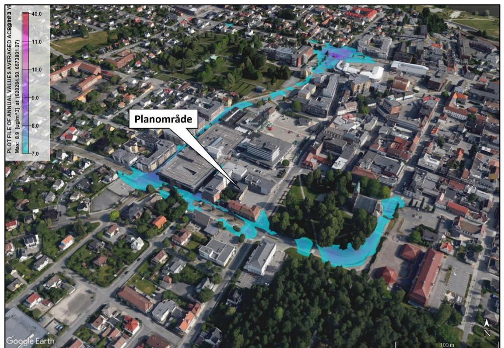
Figur 7: Konsentrasjonsutbredelse representert ved NO 2 årsmiddel ( \mu\text{g}/\text{m}^3 ) for fremskrevet situasjon (2030). Rød sone inntreffer ved 40 \mu\text{g}/\text{m}^3 . Spredningskartet er presentert i Google Earth og viser eksisterende, og ikke planlagt, bygningsmasse.
