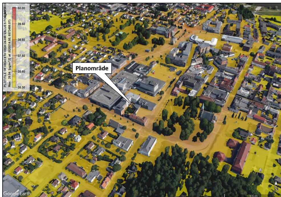
Figur 5: Konsentrasjonsutbredelse av PM_{10} i form av 8. høyeste døgnmiddel ( \mu\text{g}/\text{m}^3 ) for fremskrevet situasjon (2030). Spredningskartet er presentert i Google Earth og viser eksisterende, og ikke planlagt, bygningsmasse.
