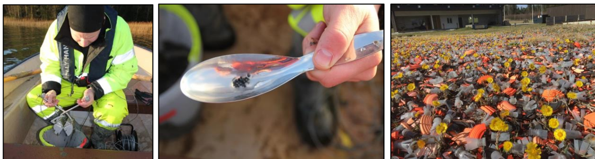
Figur 17. Sediment prøvetaking i Tunevannet november 2015 (bildet til høyre). Det ble observert store mengder hagl i sediment prøvene (bildet i midten). Bilde til høyre viser rester av leirduer og patronhetter rett utenfor standplass på skytebanen på Bekkhus, mot Tunevannet.
